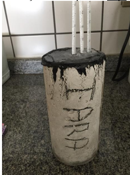
Figura 1 – Posição dos termopares no corpo de prova
