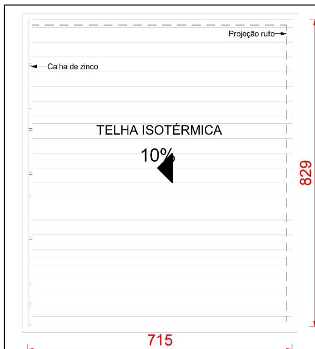
Figura 13 - Planta de cobertura embutida com telha fibrocimento
