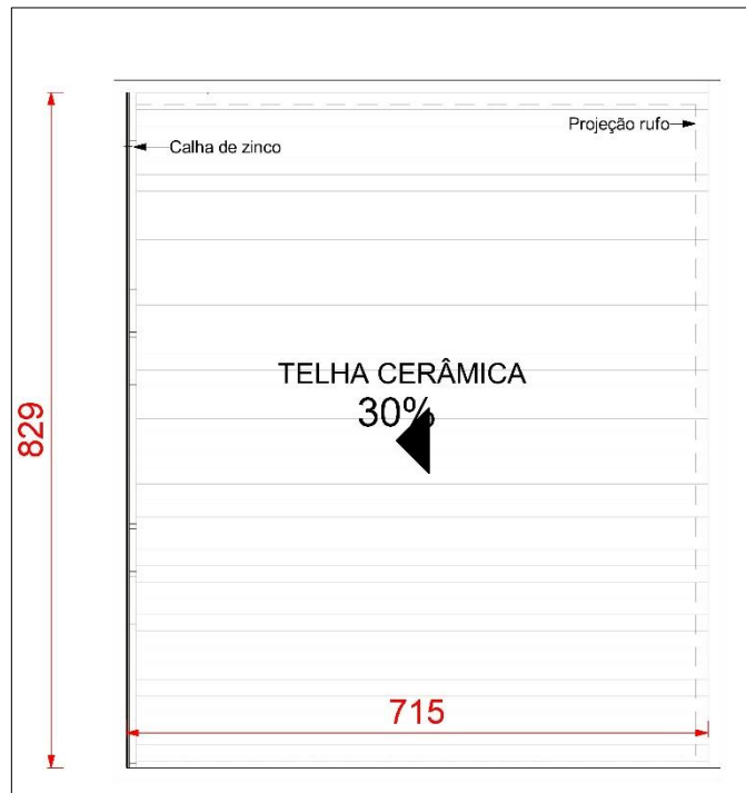
Figura 9 - Planta de cobertura embutida para telha cerâmica.
