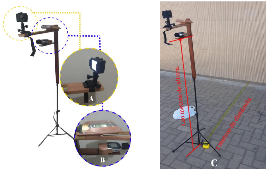
Figura 2: Sistema de suporte dos equipamentos. (A) Câmera de registro do fluxo de veículos; (B) suporte do celular e medidor de níveis sonoros; (C) Equipamentos posicionados conforme norma da ABNT NBR 10.151.
