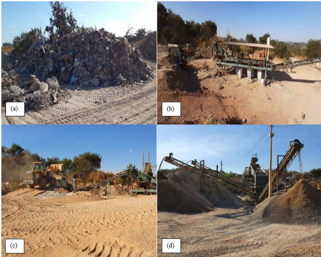
Figura 4. Etapas do processo produtivo: a) resíduos recebidos, b) triagem/separação, c) abastecimento do britador, d) britagem (Autores, 2023).
