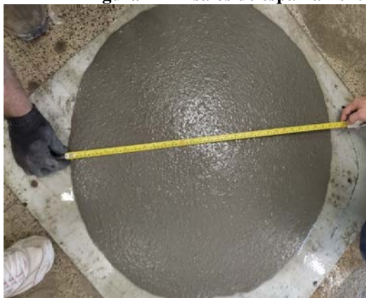
a) Ensaio de espalhamento
