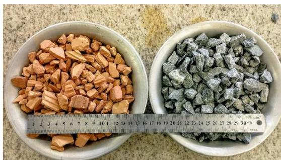
Figura 3 – Comparativo visual dos agregados graúdos
