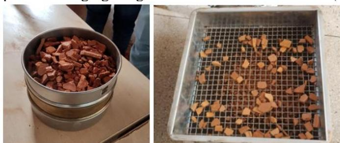
Figura 2 – Processo de peneiramento
