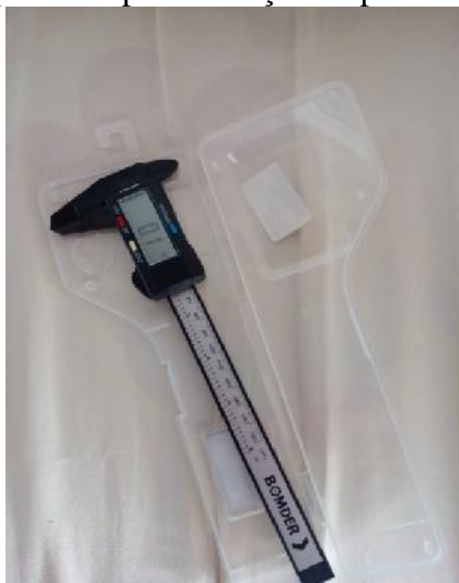
Figura 7. Equipamento para medição da profundidade de carbonatação.
