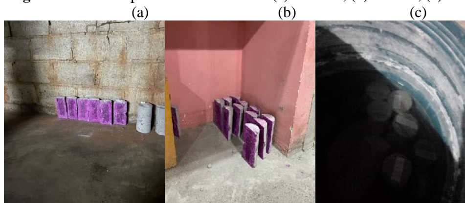
Figura 14. CP's expostos nos ambientes: (a) Externo, (b) Interno, (c) Submerso.
