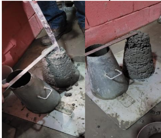
Figura 11. Teste de Slump .
