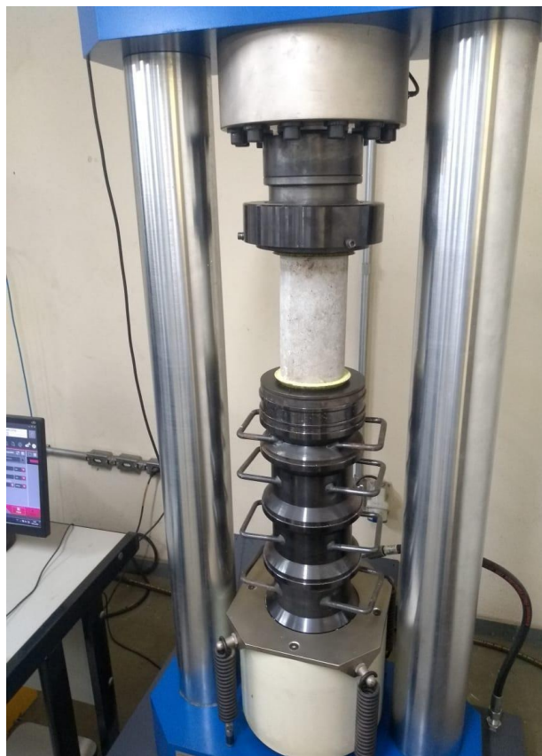
Figura 4: Ensaio de Compressão Axial.
