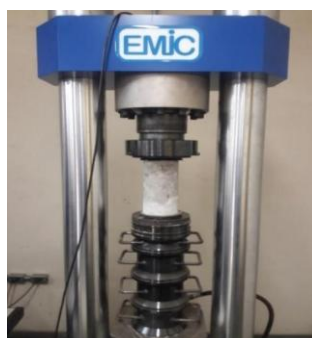
Figura 8: Corpo de prova sendo rompido à compressão axial na prensa EMIC/INSTRON
