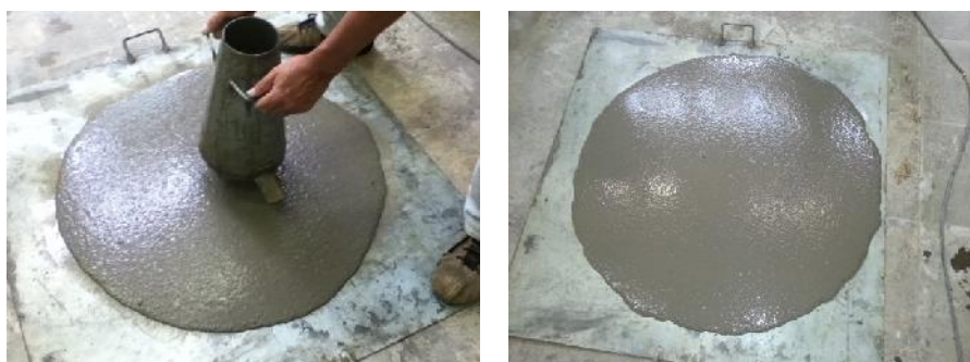
Figura 4: Ensaio de espalhamento na mesa de Graff
