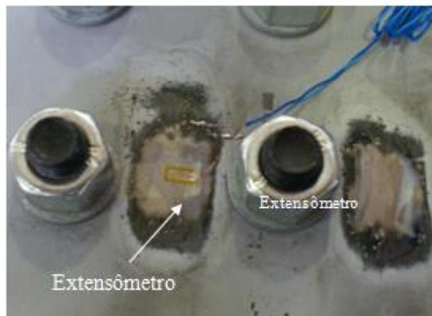
**Figura 1. Preparação da viga utilizada no ensaio.**
