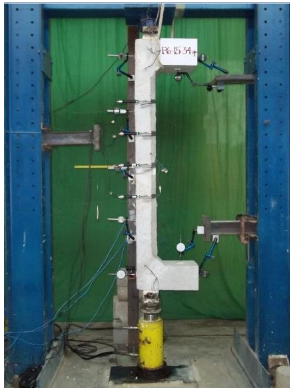
Figura 5 – Pilar posicionado para execução do ensaio de flexo-compressão reta
