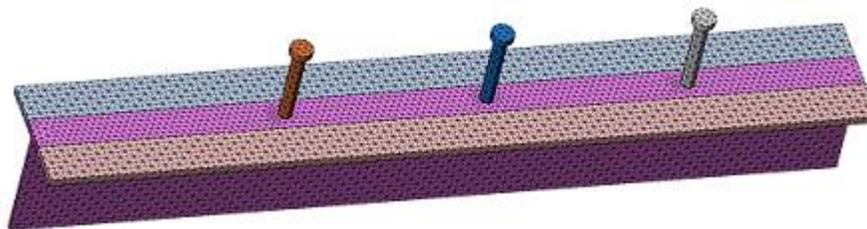
**Figura 10** – Representação do perfil e do conector
