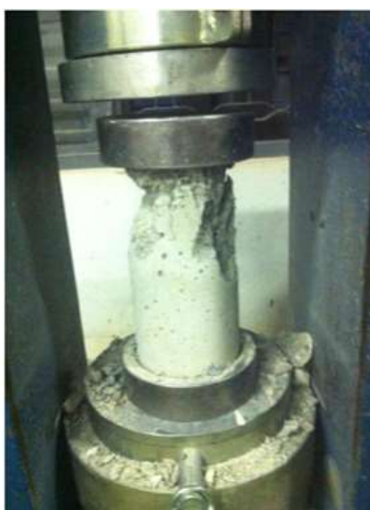
Figura 3.2 – Corpo de prova rompido na prensa hidráulica.
