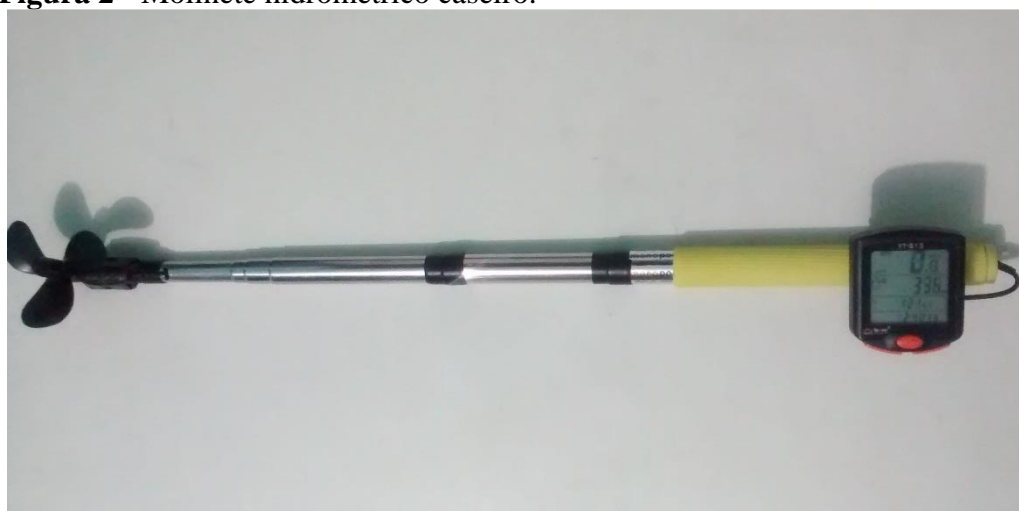
Figura 2 - Molinete hidrométrico caseiro.
