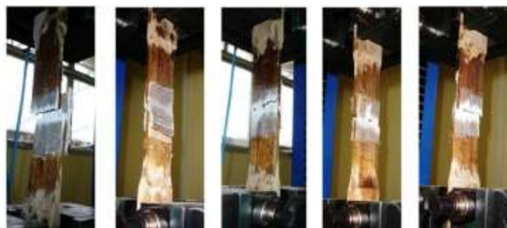
**Figura 7 - Esquema de ensaio e ruptura das madeiras, cortadas ao meio, com fibra de carbono cortada.**
