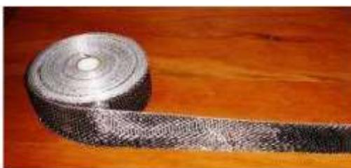
**Figura 5 - Laminado de fibra de carbono bidirecional (MOHAMMAD et. al. 2011).**
