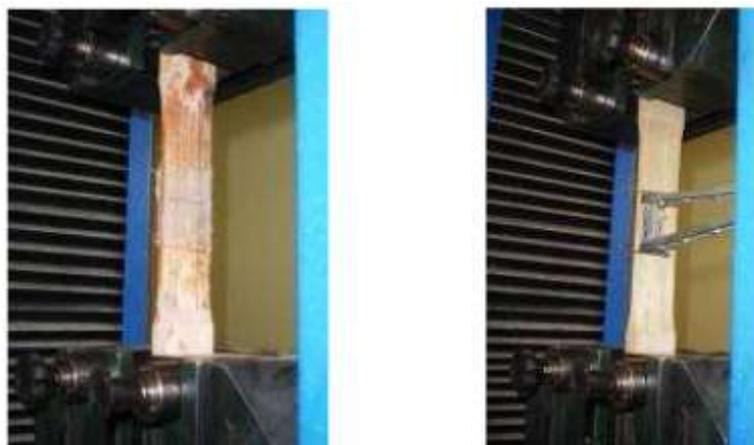
**Figura 6 - Esquema de ensaio da peça sem laminado e com laminado (MOHAMMAD et. al. 2011).**
