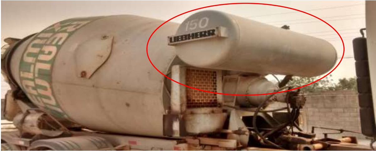
Figura 2: Caixa de água que tem capacidade de 800 litros área circulada em vermelho.
