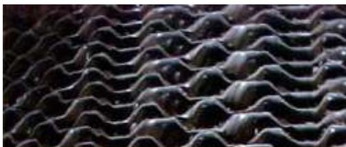
Figura 3 – Detalhe da colmeia do rotor
