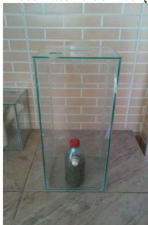
Figura 2 – Reservatório de inserção de água
