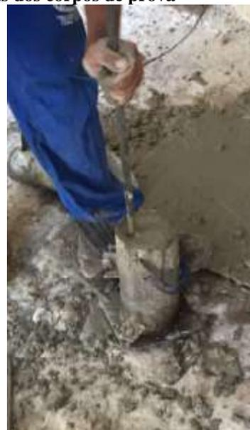
**(b) Adensamento do corpo de prova**
