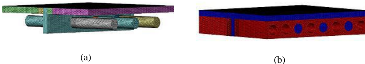
Figura 12 – Representação do (a) concreto de preenchimento e da (b) laje alveolar protendida mais concreto de preenchimento.
