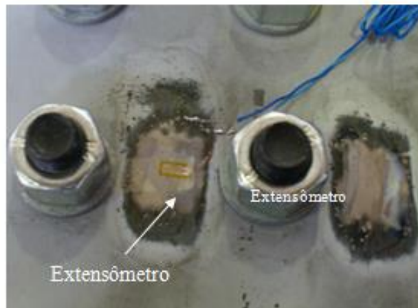
Figura 1. Preparação da viga utilizada no ensaio.
