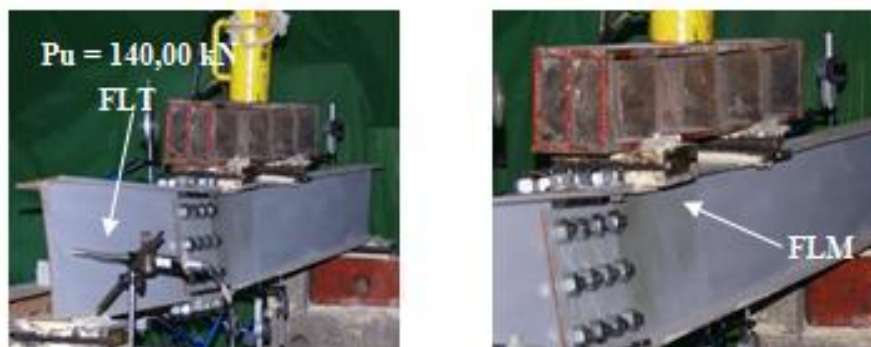
Figura 9. Modos de ruptura e carga de ruptura da viga V1LE.
