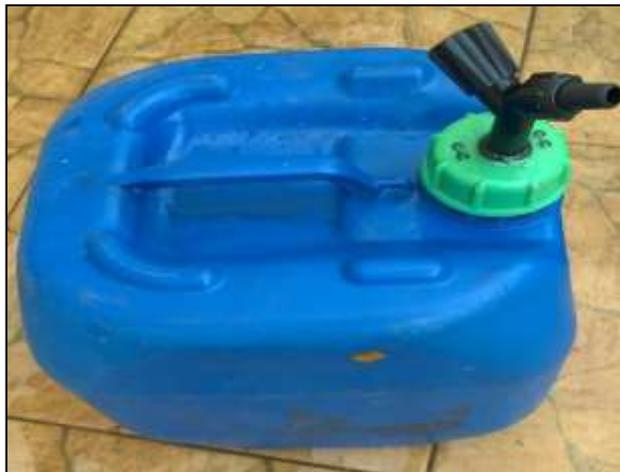
**Figura 1.** Protótipo do biodigestor caseiro.
