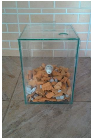
Figura 4 – Terceira câmara de filtração.
