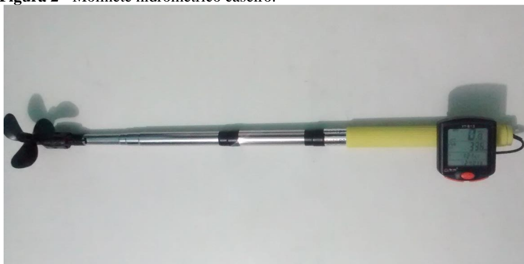
Figura 2 - Molinete hidrométrico caseiro.
