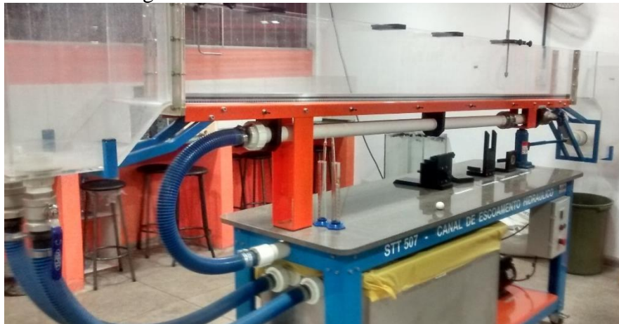
Figura 3 – Canal de escoamento hidráulico, modelo STT 507, do Laboratório de Hidráulica da Faculdade Araguáia unidade Bueno.
