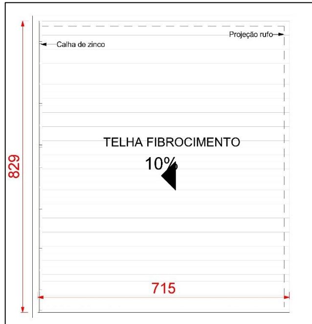
Figura 11 - Planta de cobertura embutida com telha fibrocimento
