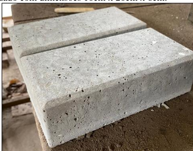
Figura 2 – Paver moldado com dimensões 10cm x 20cm x 6cm.
