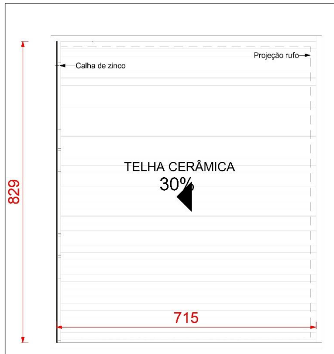
Figura 9 - Planta de cobertura embutida para telha cerâmica.
