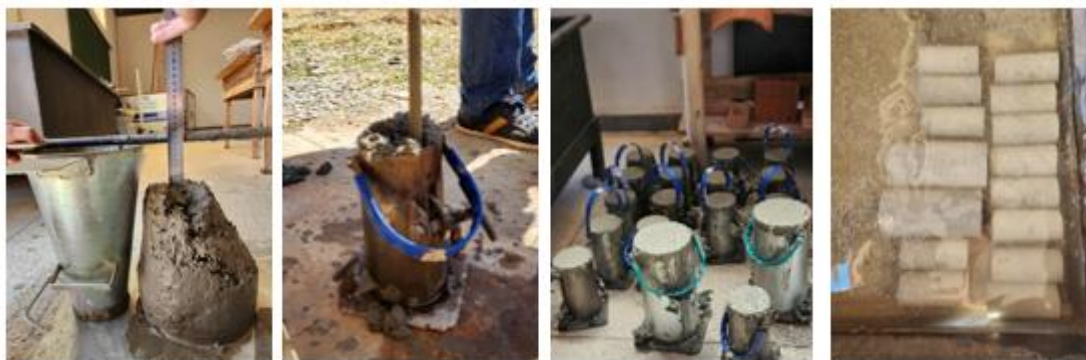
Figura 5 – Etapas: Slump test , adensamento, cura ao ar e cura por imersão.
