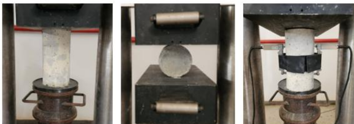
Figura 8 – Procedimentos de ensaios de compressão, tração e módulo de elasticidade.
