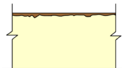
Figura 7: Trinca horizontal na alvenaria por efeito da umidade do solo (Thomaz, 1989).
