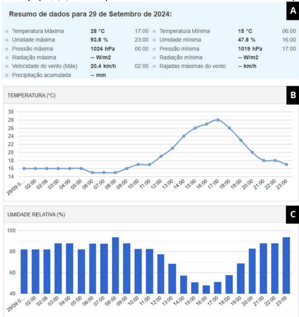
Figura 2- (A) Resumo de dados climáticos; (B) Gráfico por horário da temperatura do local de inspeção; (C) Gráfico por horário da umidade relativa do local de inspeção.
