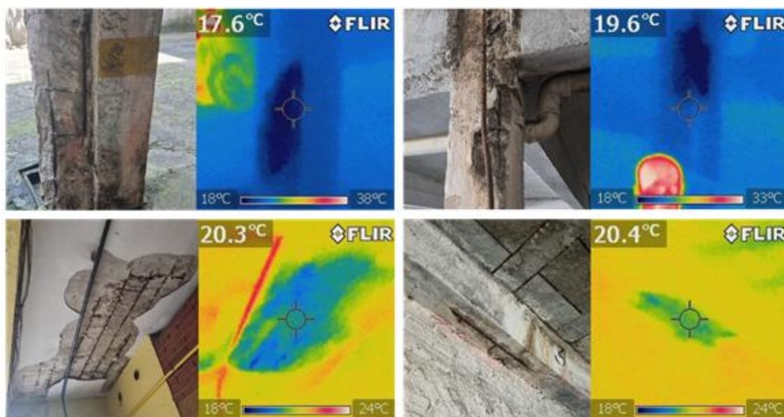
Figura 6- Imagens termográficas das áreas específicas com patologia.
