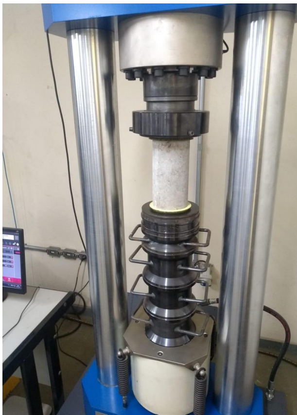
Figura 4: Ensaio de Compressão Axial.
