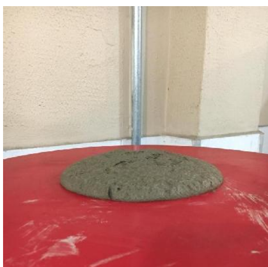
Figura 9: Consistência com argamassa contendo detergente
