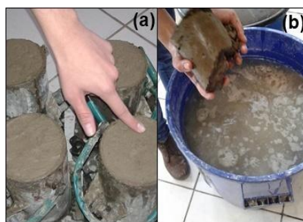
Figura 11: CP's com adição de pó de serra após 24 horas de moldagem (a) e perda dos CP'S ao iniciar o processo de cura submersa (b)
