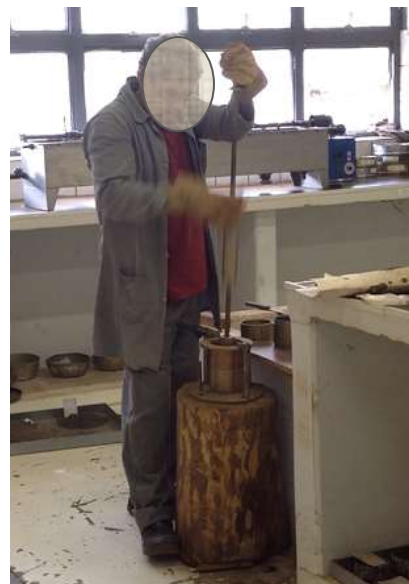
Figura 3 – Compactação de massa asfáltica (Análise B)
