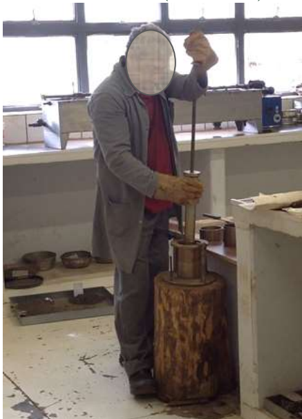
Figura 2 – Compactação de massa asfáltica (Análise A)
