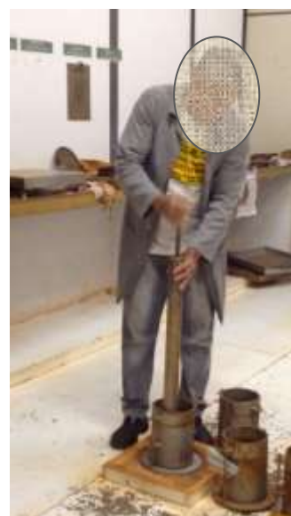
Figura 5 – Compactação de solos para ensaio de CBR (Análise D)
